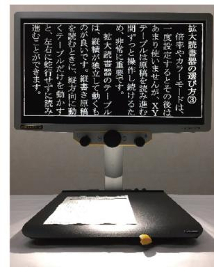
ドラマ『恋です！ヤンキー君と白杖ガール』でも使用された、拡大読書器『メゾ・フォーカス』。拡大読書器とは、弱視の方でも文字が見えるように大きく拡大し、コントラストを強調して画面に表示する機械。
